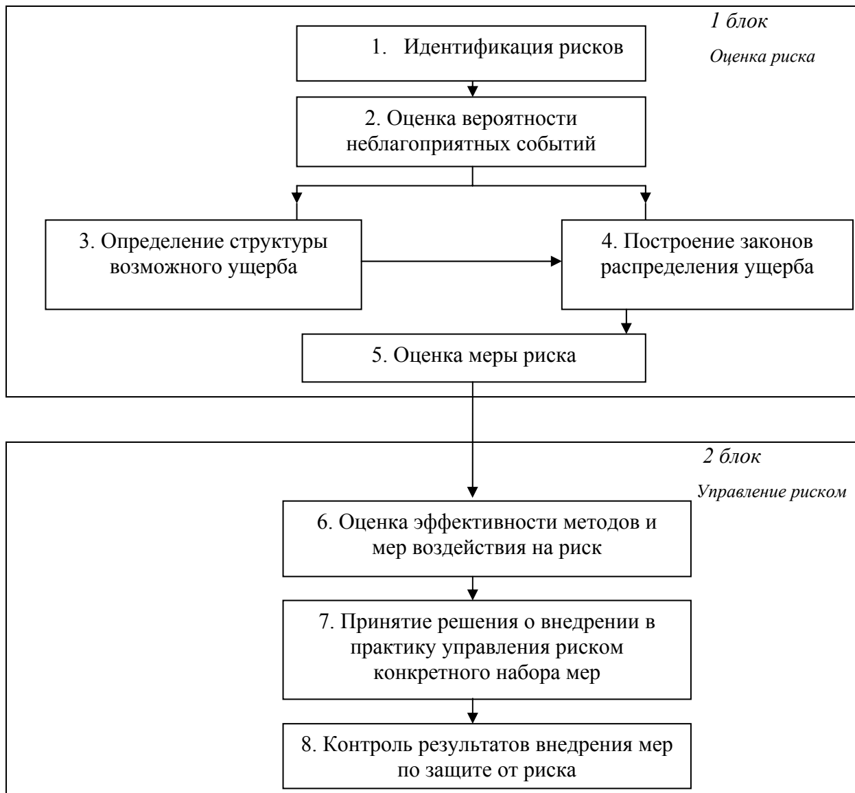
Рисунок 2 – Блок-схема этапов риск-анализа
