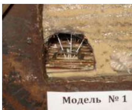
Рис. 7 Общий вид крепи выемочной выработки при использовании комбинированного способа обеспечения устойчивости при расположении лавы в средней части модели (а) и после ее полной отработки (б)
