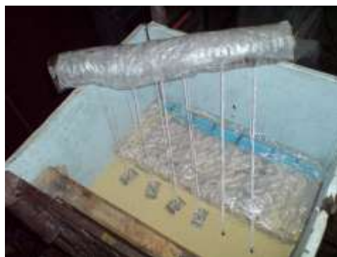
Рис. 5 Модель арочной крепи с двумя продольными балками (а) и комплект крепей с капроновыми нитями от контурных реперов перед размещением в объемной модели (б)
