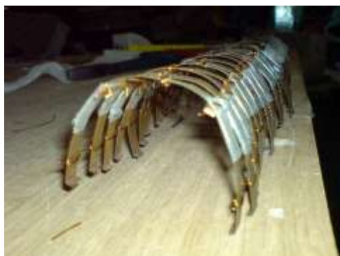
Рис. 5 Модель арочной крепи с двумя продольными балками (а) и комплект крепей с капроновыми нитями от контурных реперов перед размещением в объемной модели (б)
