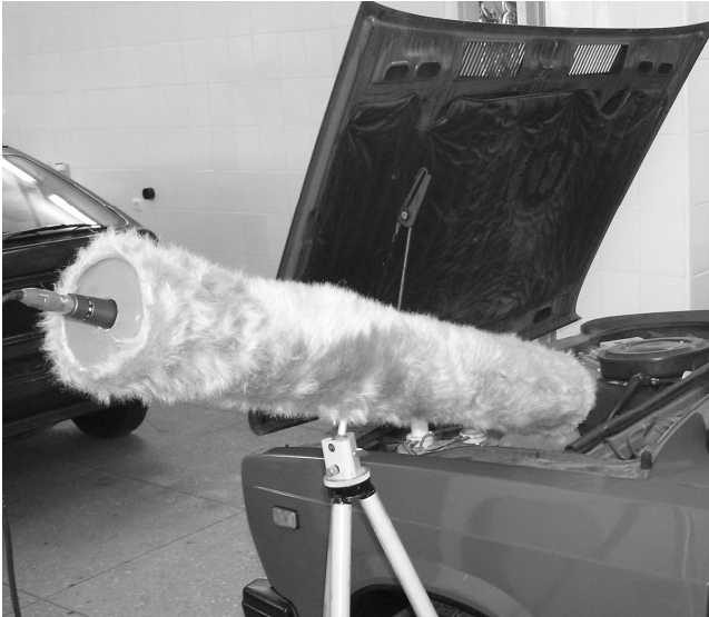
Рис. 1. Общий вид микрофона с остронаправленной характеристикой
