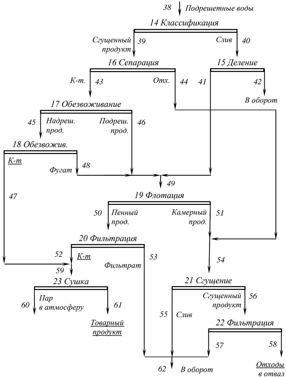
Рис. 2.1 – Технологическая схема комплекса водно-шламового хозяйства углеобогатительной фабрики
