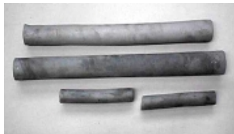
Рисунок 3 - Прессованные электроды из порошка кальцийгидридного хрома
