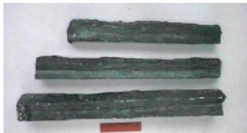
Рисунок 2 - Литые электроды, полученные алюмотермией
