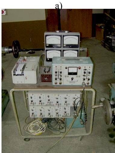
Рис. 3. Регистрирующий комплекс а) и схема его электрических соединений б): 1 - электрический разъем; 2 - тензоусилитель; 3 - показывающий прибор; 4 - избиратель пределов; 5 - переключатель входов; 6 - самописец НЗ38-1; 7 - динамометр УДМ-600
