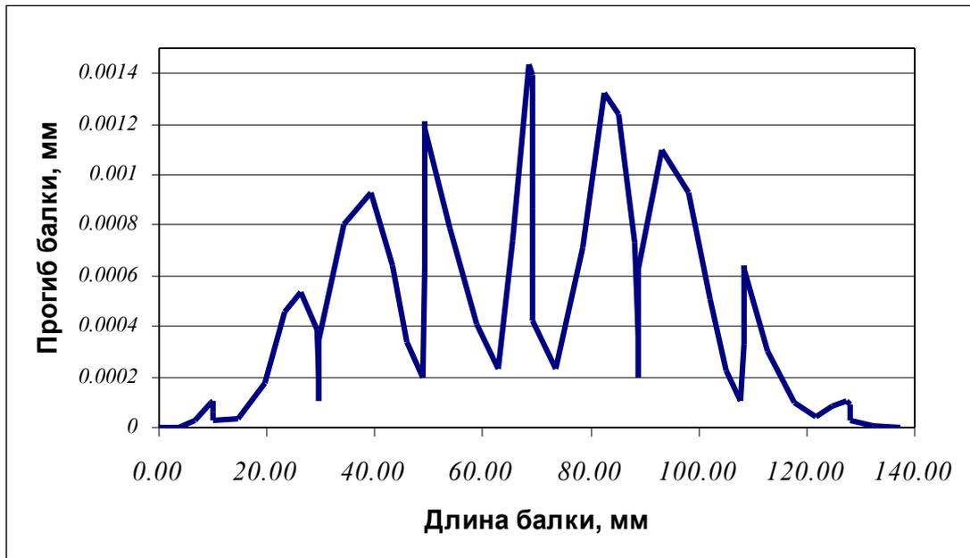
Рис. 4. Схема образования прогибов детали по пути фрезерования при обработке уступа (балки) концевой фрезой с учетом колебаний силы резания
