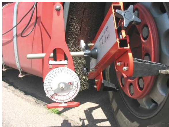
Рис. 4. Визначення кутів встановлення керованих коліс
