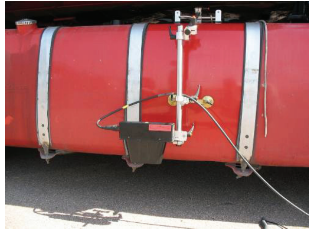
Рис. 8. Місце встановлення безконтактного оптичного датчика швидкості та шляху CORREVIT® L400
