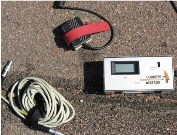
Рис. 7. Блок керування DATRON 1 – датчик зусилля на педалі; 2 – з'єднувальні дроти; 3 – блок обробки та зберігання інформації
