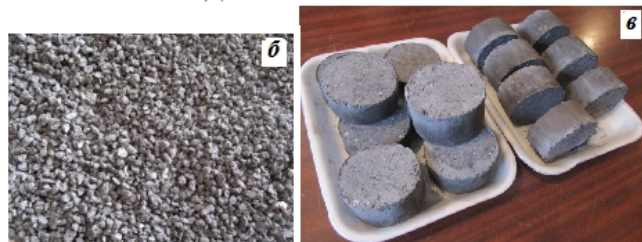
Рисунок – Изменение температуры отходящих газов во времени процесса спекания аглошихты (а) с добавкой обычного, калиброванного возврата и брикетного крошева (б), полученного дроблением исходных брикетов (в)
