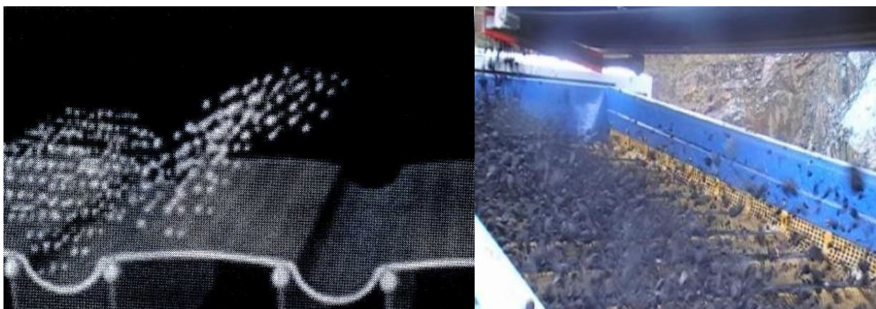
Рисунок - Грохот «Flip – Flow», принцип действия и внешний вид
