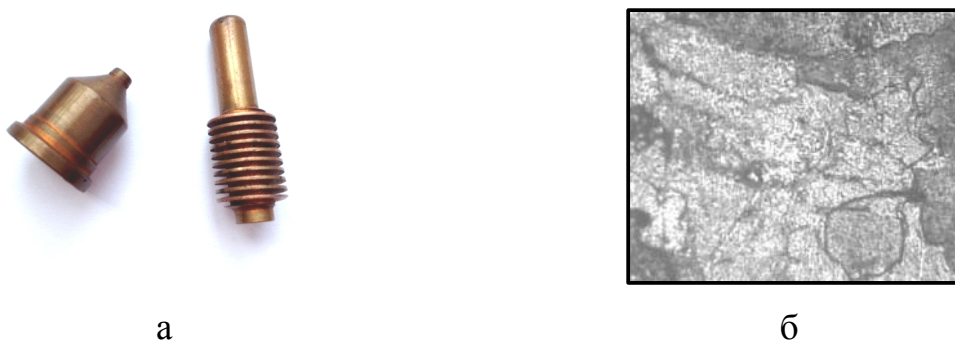
Рисунок - Внешний вид сопла и электрода плазматрона (а) и микроструктура (б) отработанного сопла (x100)
