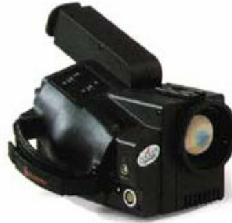
Рис 1. Внешний вид инфракрасной камеры AGEMA 570
