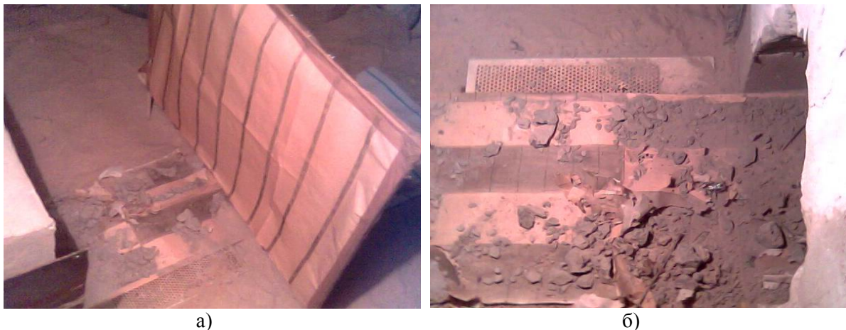
Рис. 2. Мішені для визначення траєкторії та дальності розльоту породи: а) до підривання; б) після підривання шпурів в уступній частині вибою
