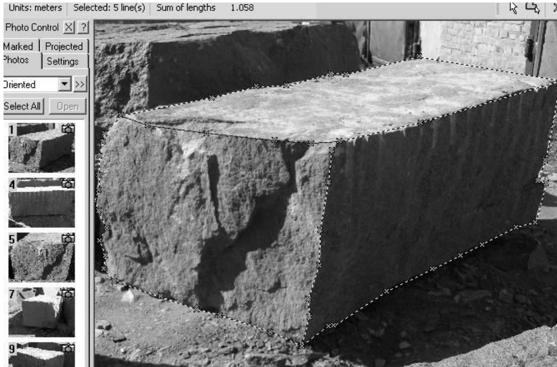
Рис. 4. Процес вимірювання ширини блока по обробленому знімку
