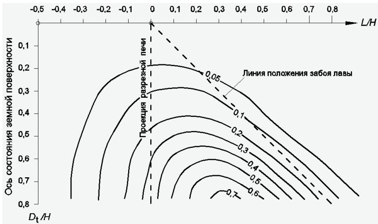
**Рис. 1.** Модель развития оседаний поверхности при формировании мульды сдвижения над движущимися забоями 605 и 607 лав пласта  $c_6'$  шахты "Юбилейная"
