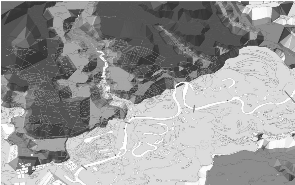
Рис. 3. Побудова тривимірної TIN-моделі об'єкту дослідження
