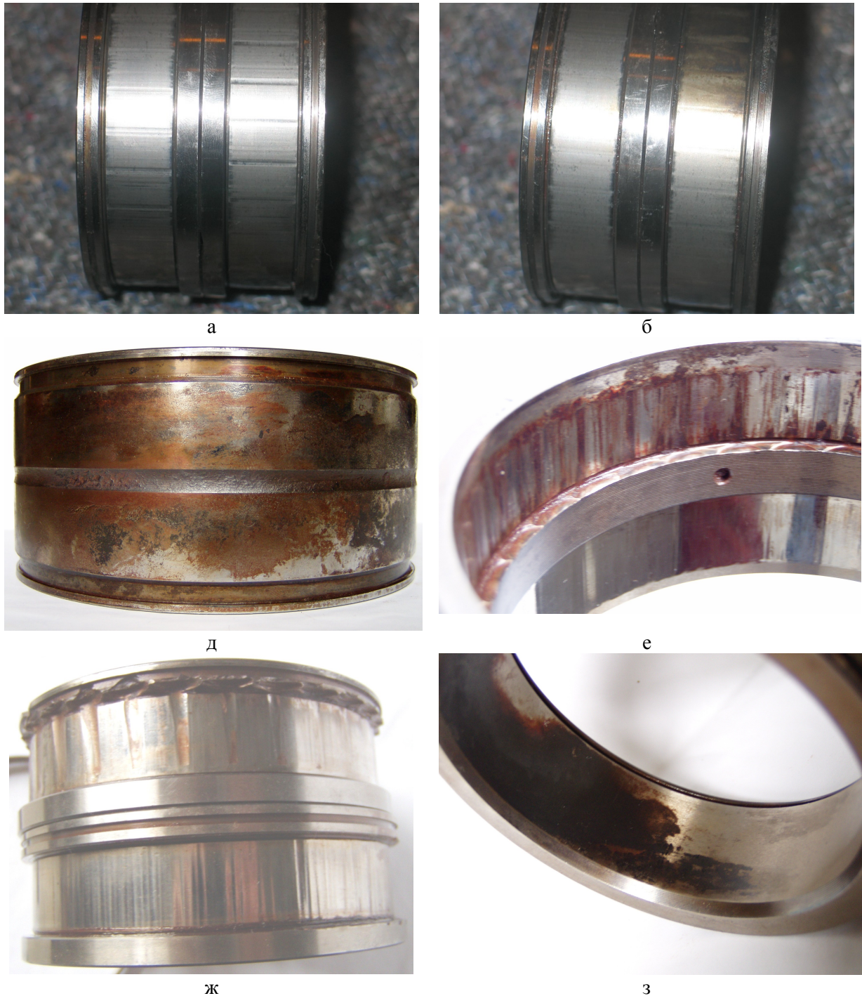
Рис. 3. Види зносу деталей підшипників NNF5016ADA-2LSV
