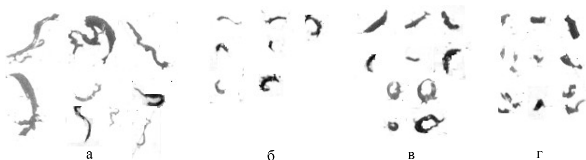
Рис. 3. Виды стружек, образующихся при плоском алмазном шлифовании: а – ленточная; б – запятообразная; в – сегментообразная; г – дробленая
