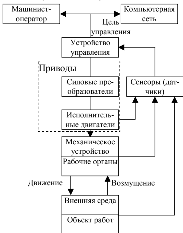
Рисунок 1 - Типовая схема машины с компьютерным управлением
